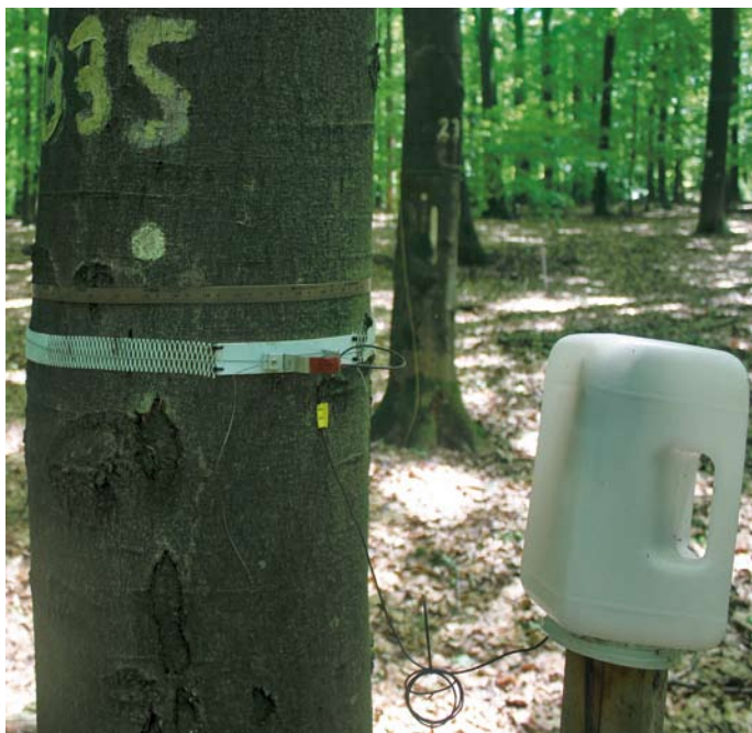
Kontinuierliche (Dendrometer) und periodische (Dauerumfangmessband) Zuwachsmessung im Intensiven Monitoring
