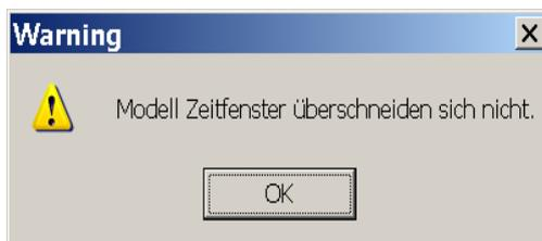
Hier ist eine Korrektur der Startzeit oder des Ende der Simulation (in Abhängigkeit der verwendeten Regenreihe) erforderlich.
