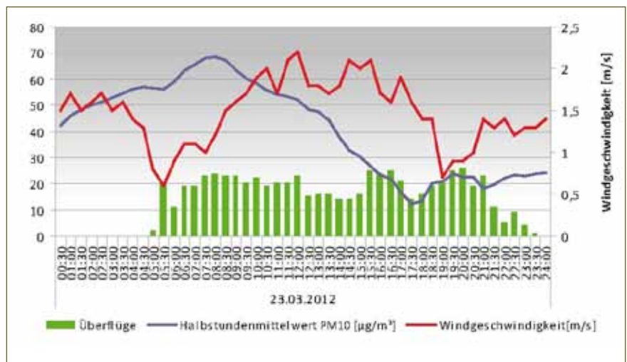
Einfluss der Überflüge und der Windgeschwindigkeit auf die Feinstaubbelastung (Quelle: HLUG und Caspar Live Aircraft Tracking)
