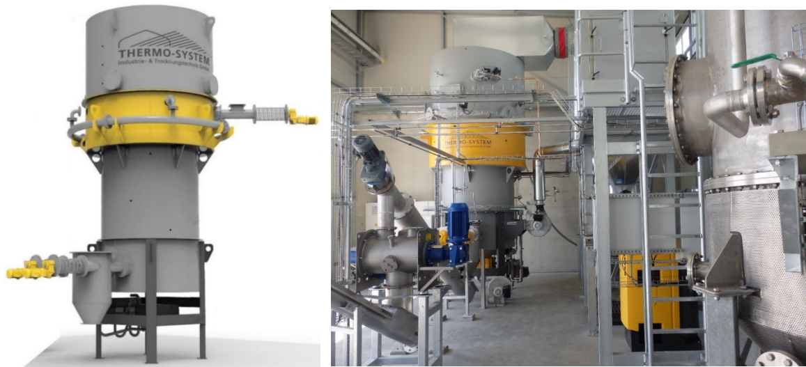
Abb. 3-14: KlärschlammReformer, Fa. Thermo-System auf der Kläranlage Renningen (Thermo-System, 2020)
