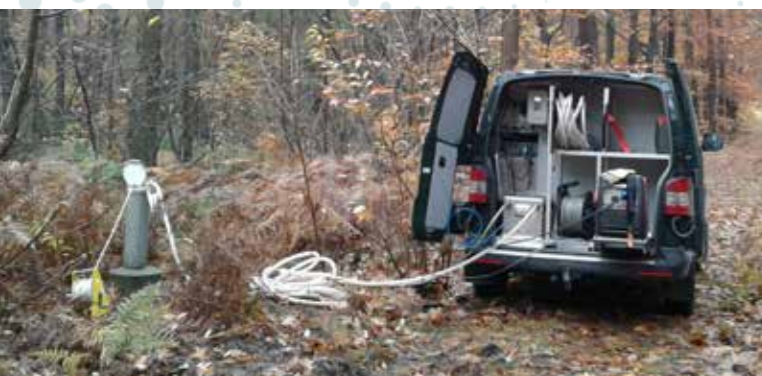
Probenahmefahrzeug zur Bestimmung der Vor-Ort-Parameter wie z. B. Wassertemperatur oder pH-Wert.
