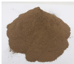
Asche aus Klärschlamm-Monoverbrennung. Quelle: Prof. Dr. Weigand, THM, 2018
