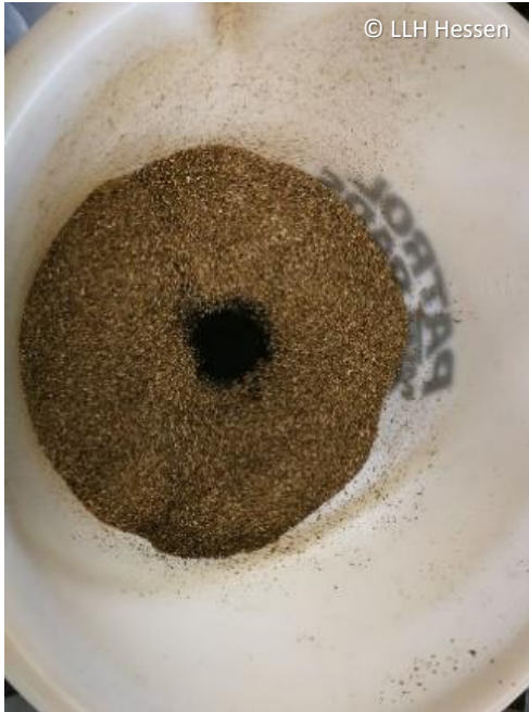
5 kg P-Null-Substrat mit Rezyklatmenge auf Basis von 0,75 g Ges.-P 2 O 5 ; manuell gefäßweise vermischt
