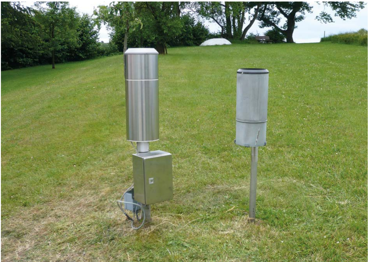
Abbildung 30: Niederschlagsmessstelle Freiensteinau: links: Pluviometer, rechts: Hellmann-Messgerät
