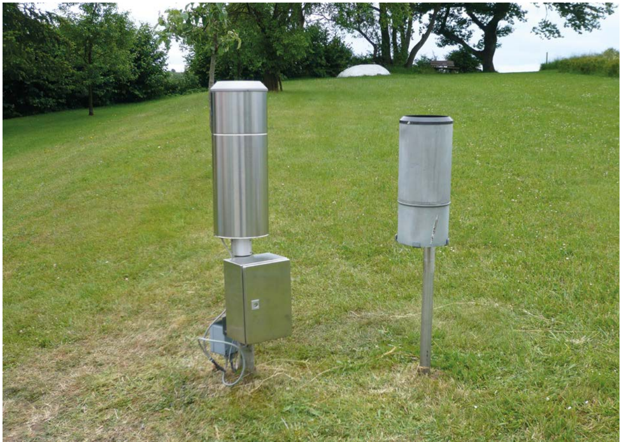
Abbildung 30: Niederschlagsmessstelle Freiensteinau: links: Pluviometer, rechts: Hellmann-Messgerät
