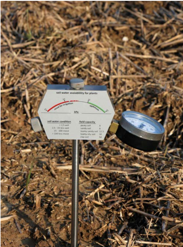
Einsatz eines Tensiometers zur Kontrolle der Bodenfeuchte im Rahmen einer bodenkundlichen Baubegleitung
