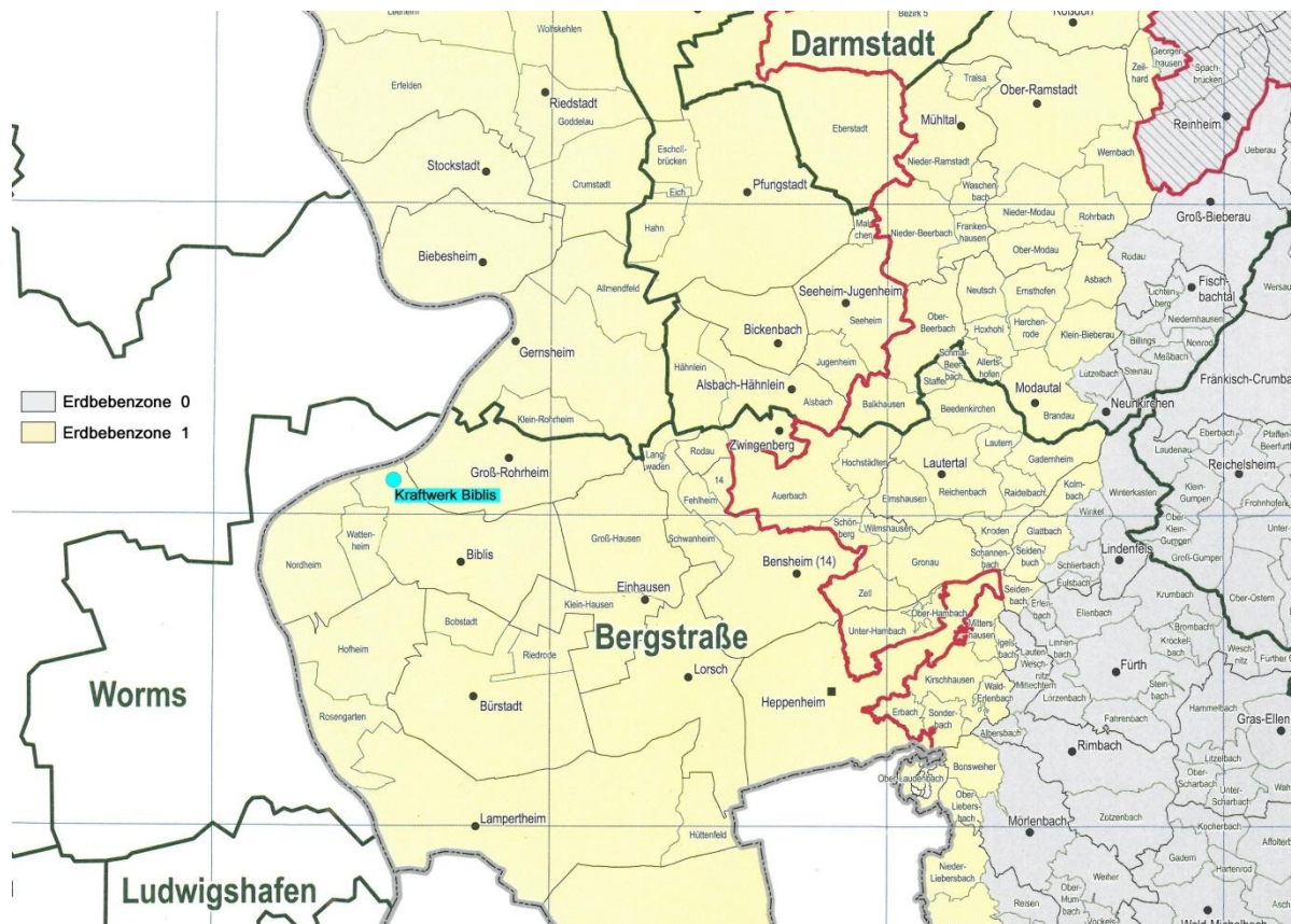
Abbildung 6: Kennzeichnung des KWB in der Planungskarte zur DIN 4149: 2005-04
