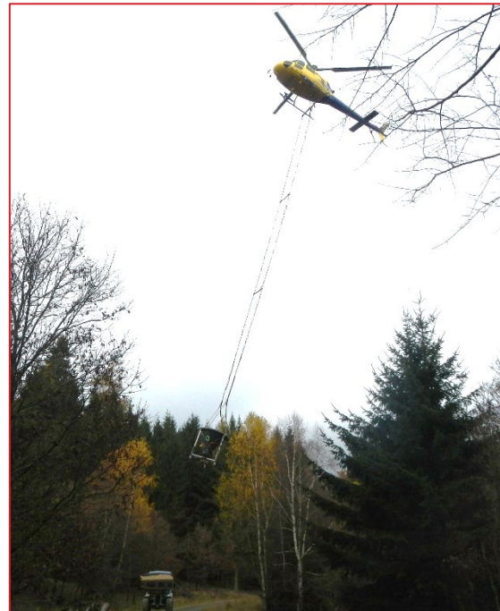
Abbildung 12: Transport des Magnesiumkalks per Hubschrauber
