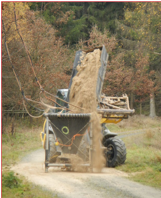
Abbildung 11: Befüllung des Ausbringungstrichters mit Magnesiumkalk
