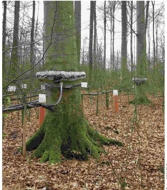
Konstruktion zur Stammablaufmessung auf der Level II-Fläche Krofdorf
