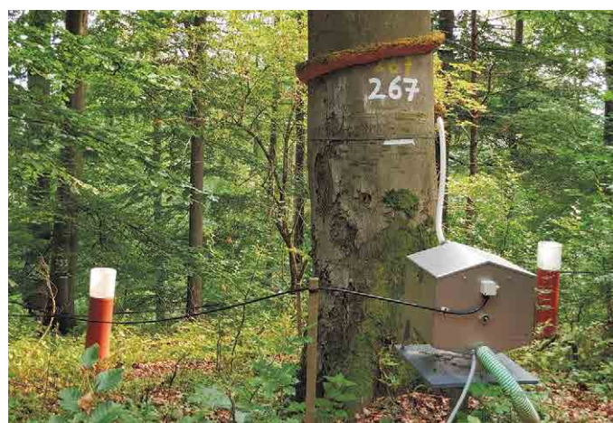
Kippsschale zur Erfassung des Stammablaufs (Zierenberg)
